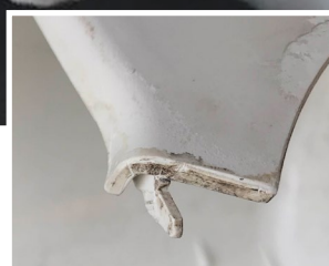
W TRAKCIE CZYSZCZENIA: Silnie zanieczyszczony element usunięty z formy po zastosowaniu środka Lusin® MC1718
