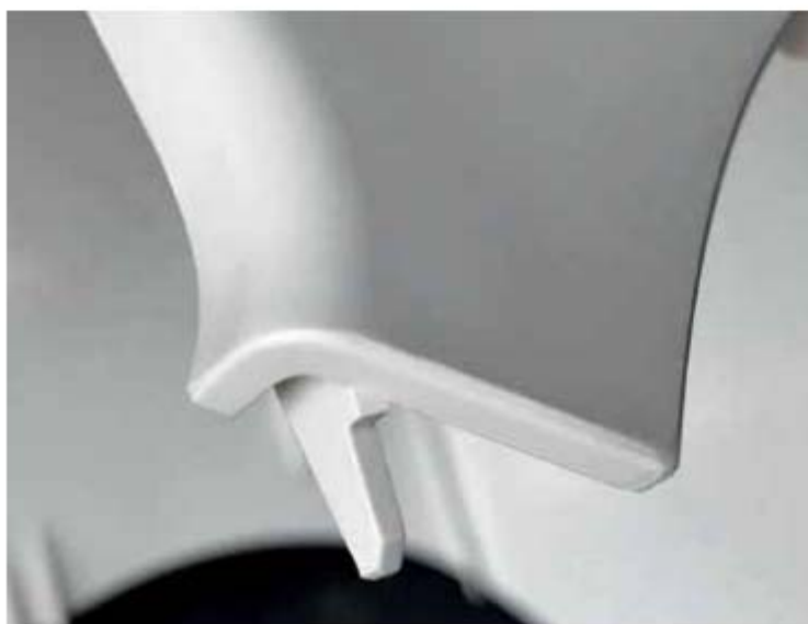
Rys. 3 | Część po oczyszczeniu formy za pomocą LUSIN MC1718
