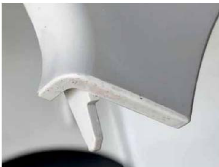
Rys. 1 | Osad na wyprasce przed czyszczeniem formy
