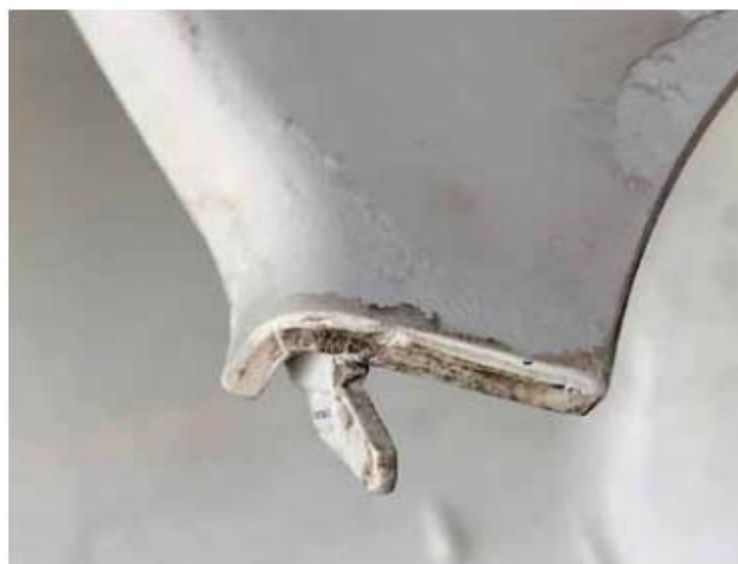
Rys. 2 | Osad na wyprasce zebrany z formy zaraz po zastosowaniu LUSIN MC1718
